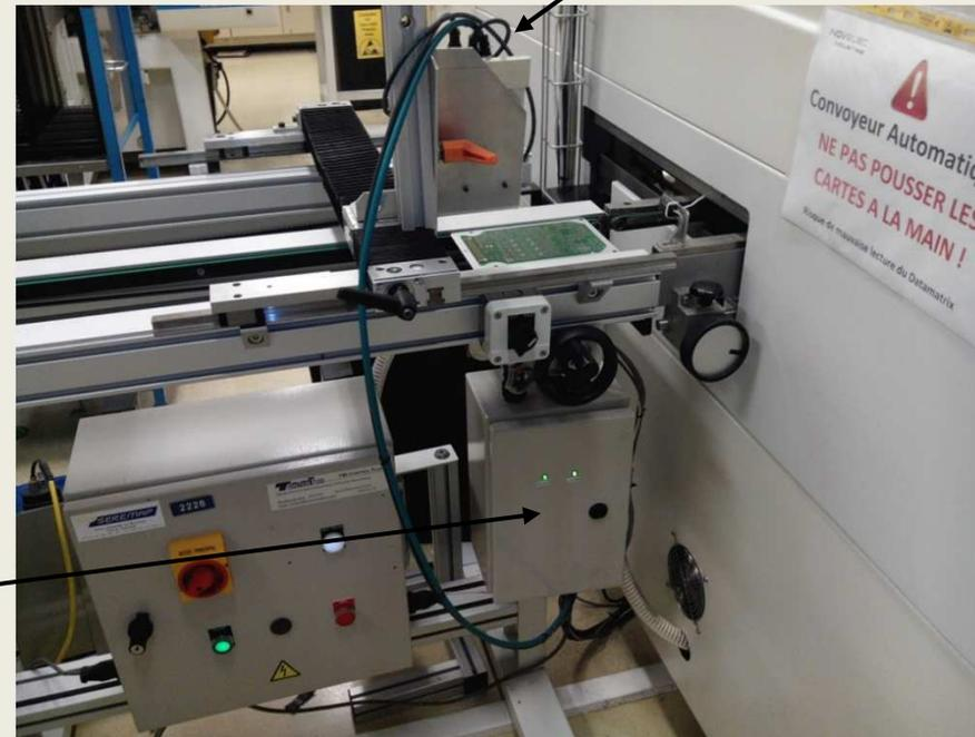
Boitier de communication Ethernet entre convoyeur et machine
